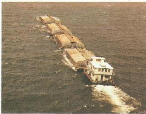
Fig. 12.23 — Comboio formado por quatro chatas e uma empuradora, na hidrovia Tiet-Paran.
